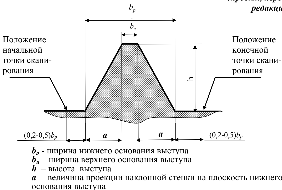
Рисунок 1 – Сечение поверяемого элемента рельефной меры с обозначениями поверяемых параметров
